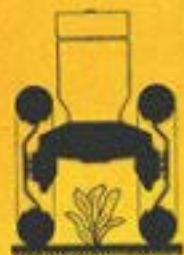
Position haute dans les cultures en ligne. Écartement faible.
