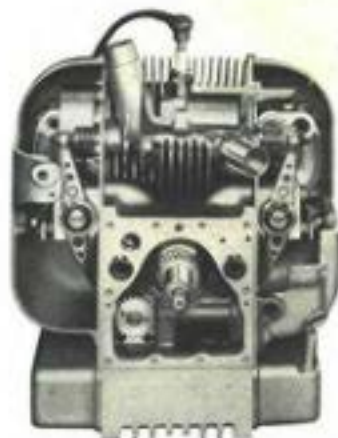
Coupe du moteur à pistons opposés
