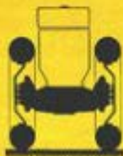
Position surbaissée pour le fauchage. Écartement faible.
