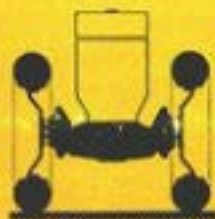
Position surbaissée pour le fauchage sur pentes. Écartement large.
